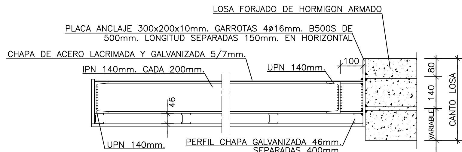
SECCION K-K (Cotas en mm) ESCALA: 1/10
