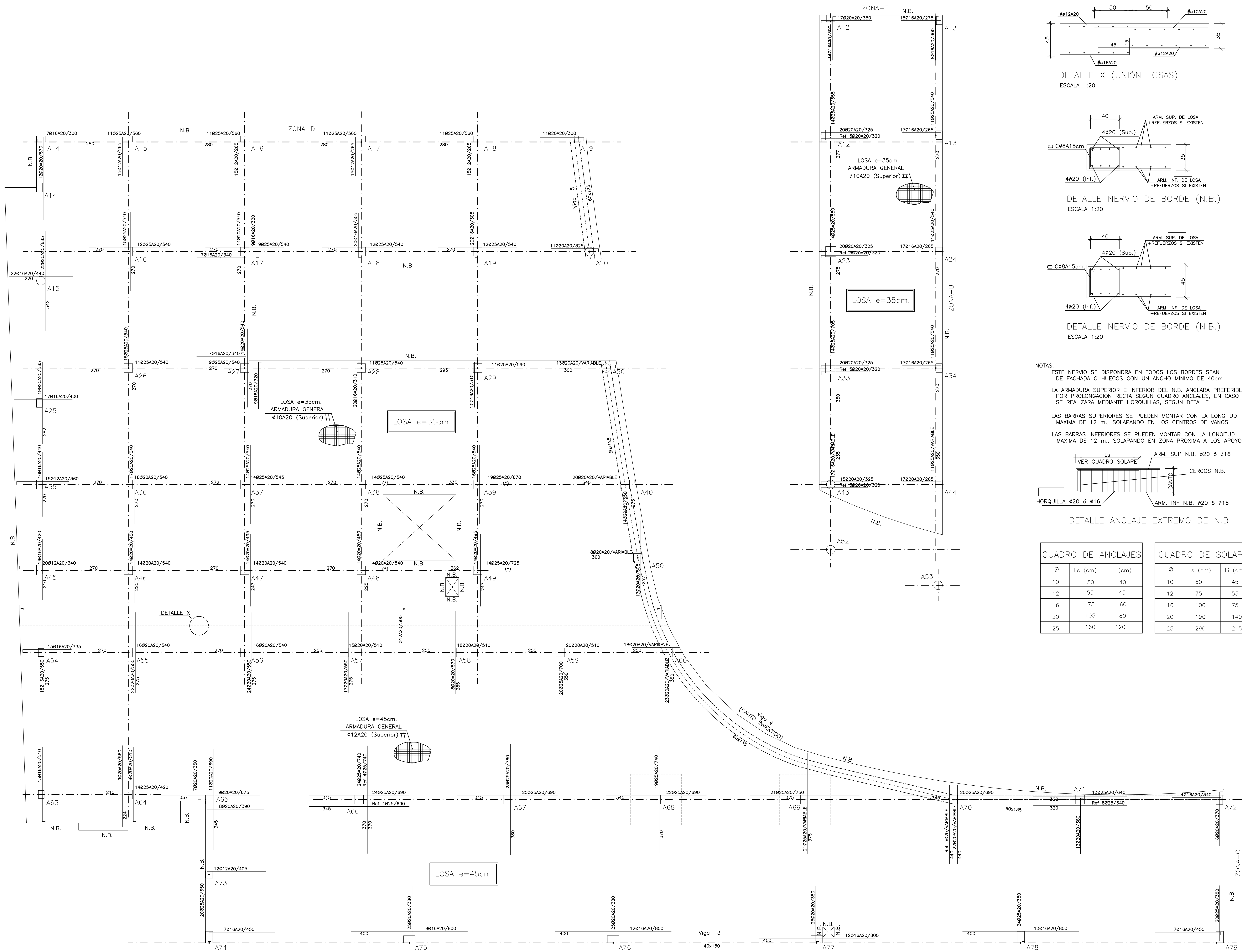
PLANTA CUBIERTA (+114.90) ARMADURA SUPERIOR
